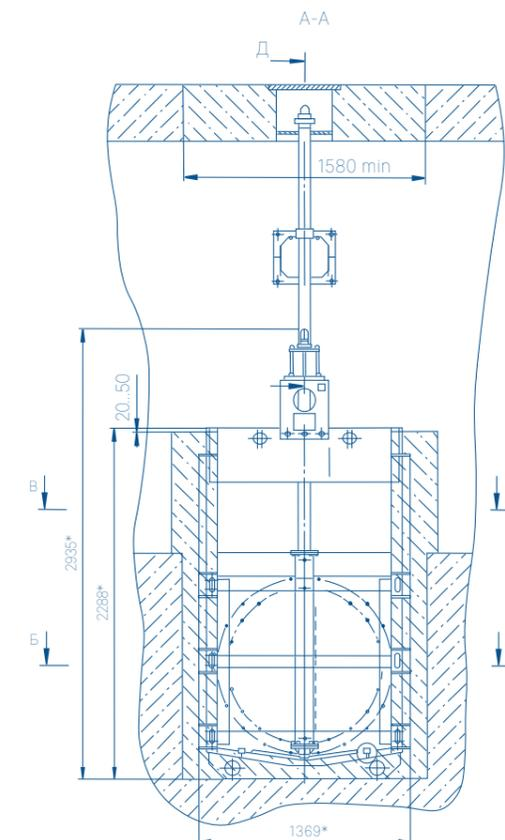
**Обозначение** Затвор щитовой глубинный EAZ
